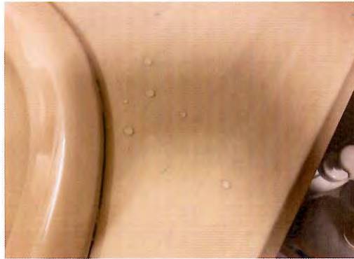
【施工後：トイレ洗面カウンター：撥水】
